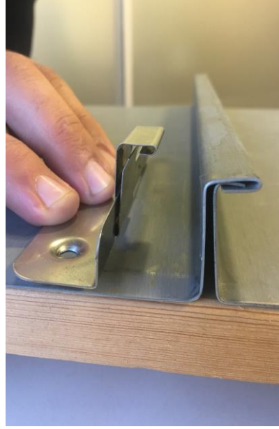
Hareketli klips (orjinal paslanmaz) Kenet hadve yüksekliği = 25 mm
